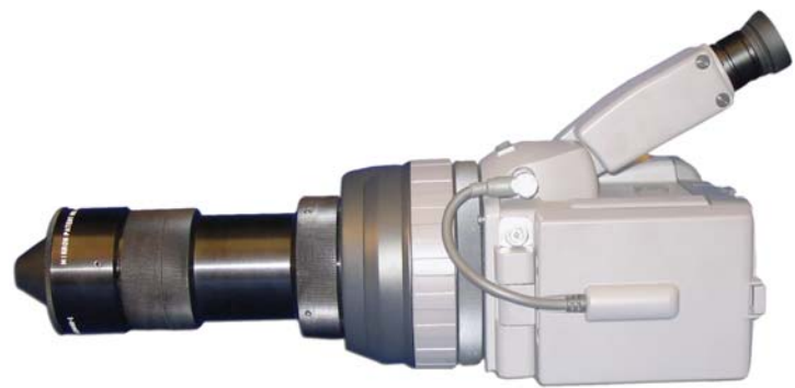
使用鱼镜头检测燃烧孔及炉壁
