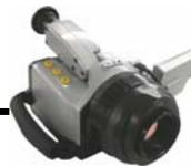
TH9100 配合软件，通过 IEEE1394 测定刹车碟的温度变化过程，改善刹车碟表现
