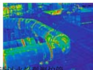
透过火焰观测炉管
