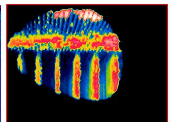
透过大火焰观测炉管
